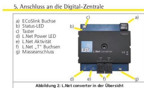
Figura 2: Quadro d'insieme dei componenti l'L.Net converter
